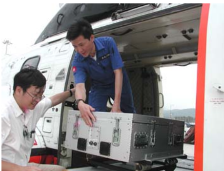
天文台人員正把空中輻射監測系統安裝在政府飛行服務隊的直升機上
